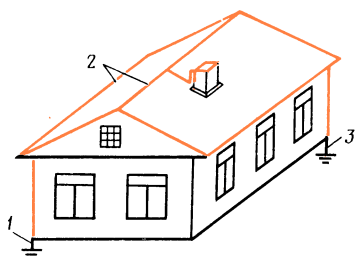
Рис. 125. Схема прокладки молниезащитных проводников по коньку крыши:
